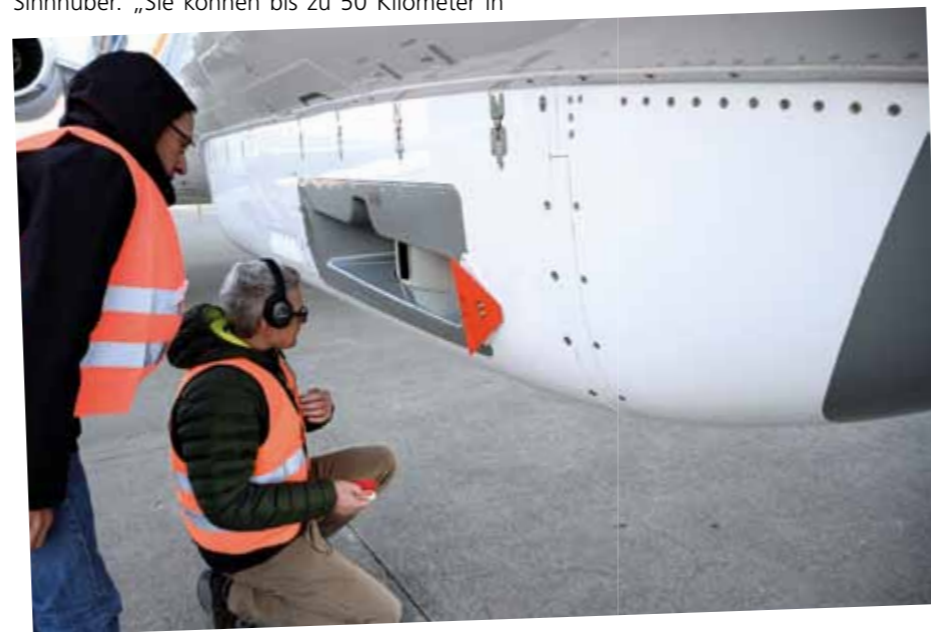
Das GLORIA Instrument an der Rumpfunterseite des Forschungsflugzeugs HALO.
