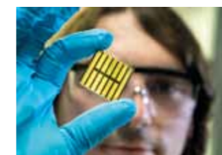
Hoffnungsträger Solartechnik: Forschung an einer Perowskit-Solarzelle Hope for solar technology: Research on a perovskite solar cell
